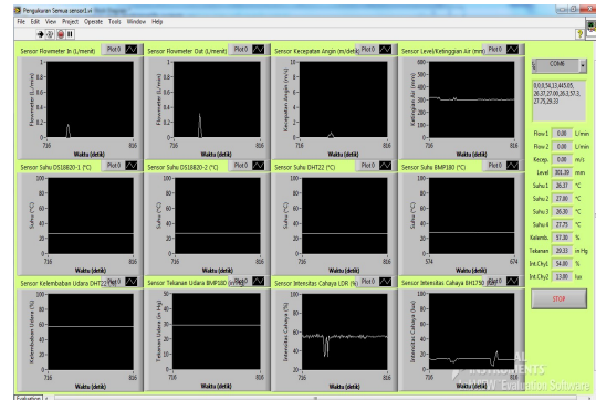
Gambar 4. Data sensor ditampilkan dalam bentuk grafik di software LabVIEW
