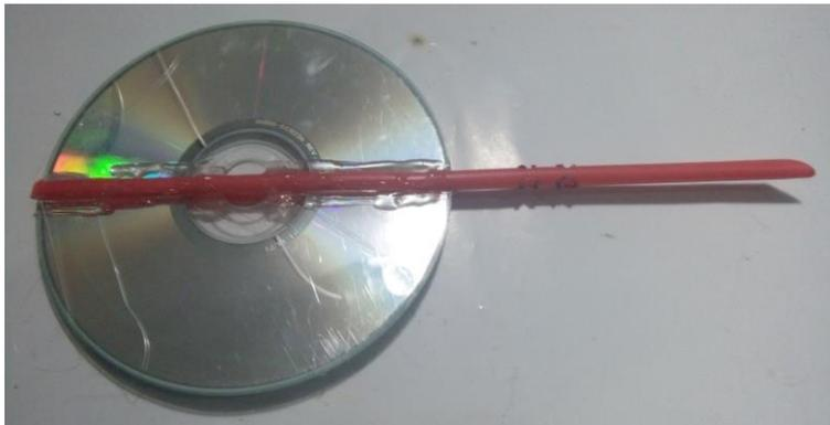
**Gambar 6.16 Menempelkan batang plastik pada CD bekas untuk penangkap angin**
