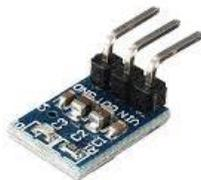
**Gambar 7.9 Modul AMS1117 regulator 3,3V dengan kapasitor decoupling**
