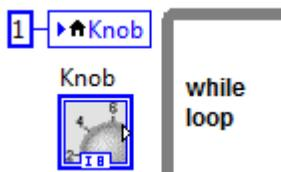
**Gambar 5.62 Klik kanan Knob, pilih Create Local Variable, tempatkan di luar kotak While Loop, dan beri input 1 agar secara default memilih pengaturan no. 1**
