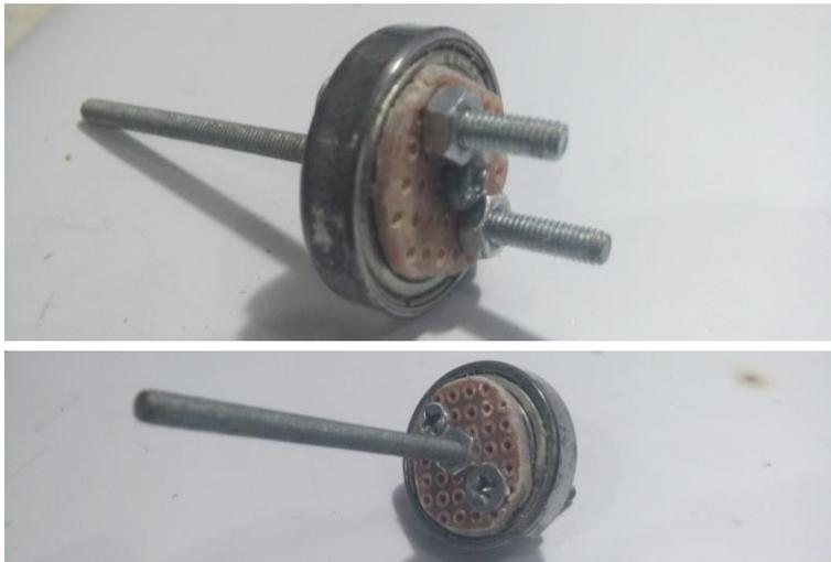
***Gambar 6.14 PCB di Bearing dikunci dengan M2 pendek di pinggir, dan M2 panjang di tengah***
