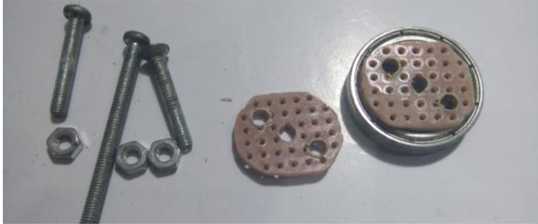
***Gambar 6.13 Apit Bearing dengan 2 potongan PCB yang telah dilubangi***
