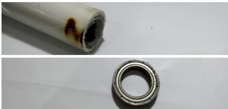
**Gambar 6.10 Menambahkan Bearing pada ujung pipa untuk penempatan poros bermagnet**
