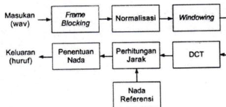
Gambar 5. Blok Diagram Sistem Pengenalan Nada Pianika
