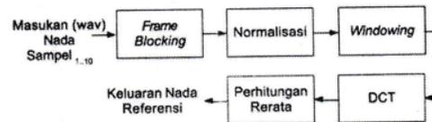
Gambar 6. Blok Diagram Proses Pengambilan Nada Referensi
