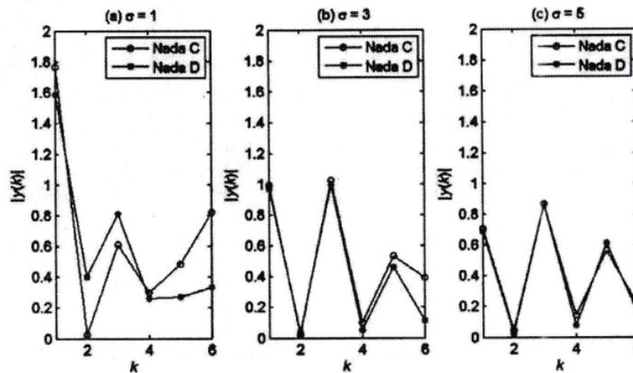
Gambar 7. Pengaruh Standar Deviasi Jendela Gaussian,  $\sigma$ , terhadap Hasil DCT,  $|y(k)|$ , untuk Penggunaan Panjang DCT,  $n = 32$  Titik, dan Persen Koefisien DCT  $\rho = 20\%$
