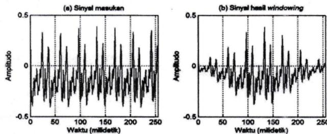
Gambar 3. Contoh *Windowing* pada Suatu Sinyal. Jendela yang Digunakan adalah Jendela Gaussian 256 Titik, dengan Deviasi Standar  $\sigma = 2$
