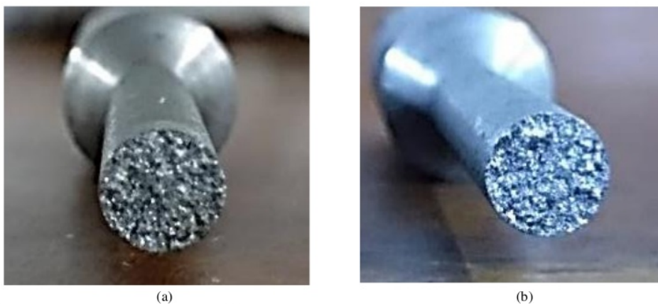
Gambar 5. Bentuk patahan spesimen uji leleh (a) komposisi 2,9% Si (b) komposisi 3,8% Si.
