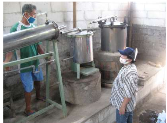
Gbr. 3 Peralatan penyulingan minyak atsiri sirih
