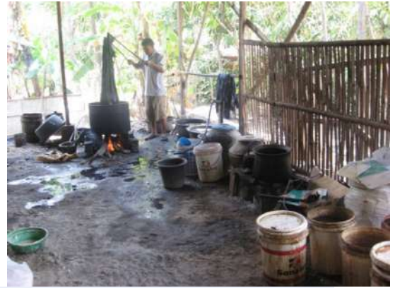
Gambar 1. Ketel untuk merebus kain batik
