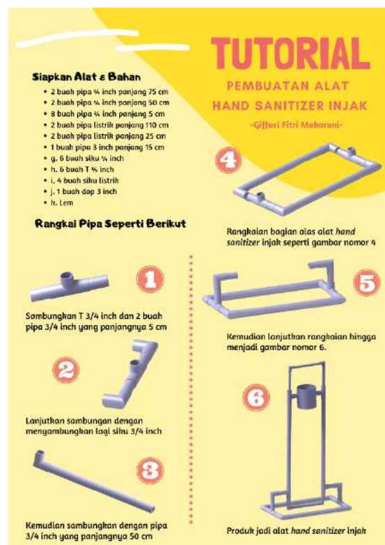
Gbr. 2 Poster Tutorial Pembuatan Alat Hand Sanitizer Injak
