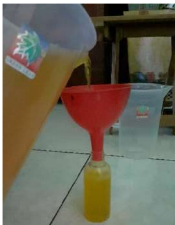
Gbr 4. Pencampuran ekstrak kulit jeruk dengan etanol, gliserin dan air suling
