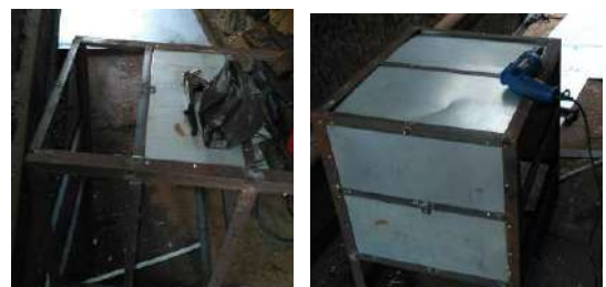
Gbr. 1 Pembuatan rak peralatan tempa dan benda kerja (Sumber: Mijil Karya, 2018)
