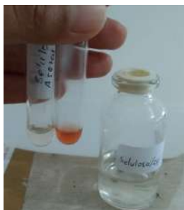
Gbr. 8 Uji larutan ion Fe sebelum adsorpsi dan setelah adsorpsi menggunakan pengompleks KSCN.
