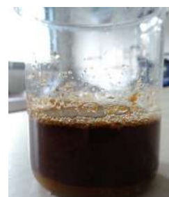
Gbr. 1 Serbuk kayu ditambah alkali NaOH
