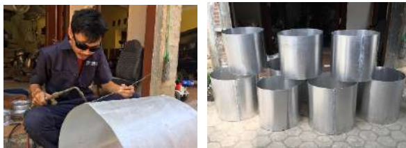
Gambar 4. Pengerjaan dinding keliling dandang
