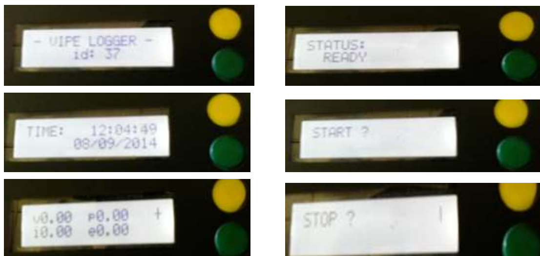
Gambar 14 Tampilan LCD saat datalogger dioperasikan.
