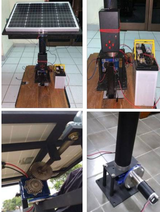
Gambar 7. Sistem mekanik pelacak cahaya
