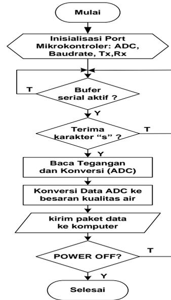
Gambar 2. Diagram alir program perangkat keras mikrokontroler
