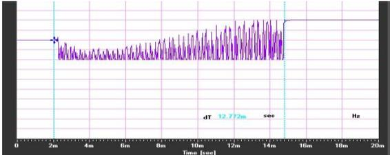
Gambar 5. Sinyal satu paket data pada port Tx
