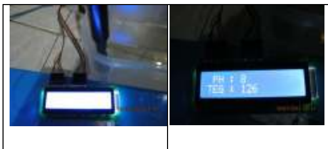
Gambar 4. Prototipe alat ukur pH air yang telah dibuat dan tampilan hasil pengukuran sampel air
