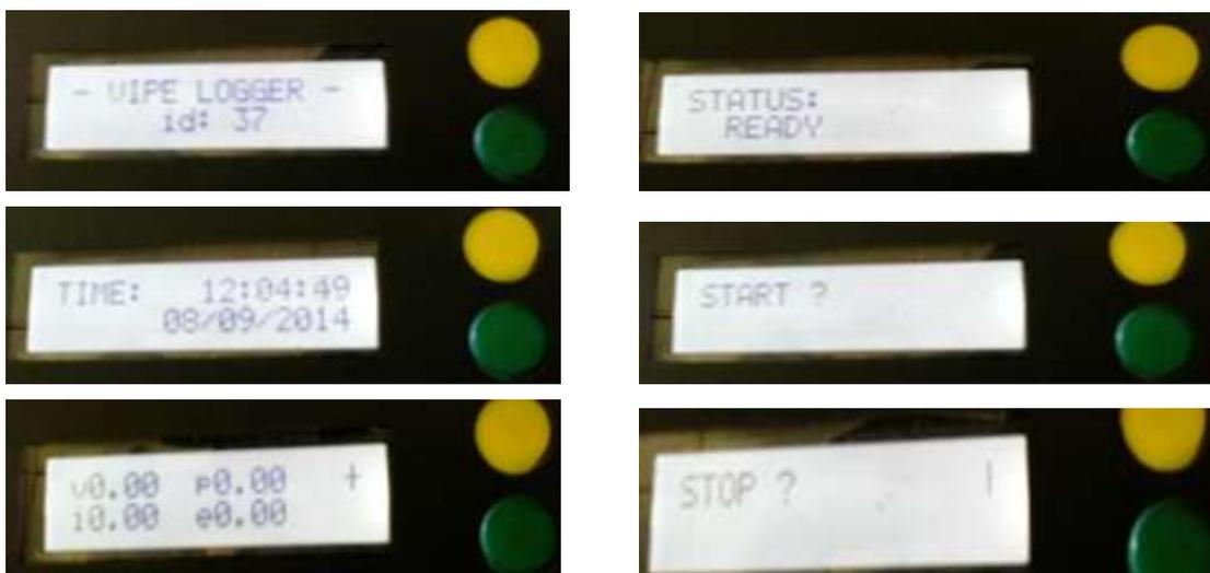
Gambar 14 Tampilan LCD saat datalogger dioperasikan.
