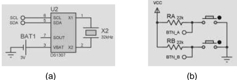
Gambar 8(a) Rangkaian RTC. (b) Rangkaian Tombol Tekan.
