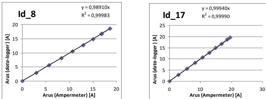
Gambar 13 Kurva perbandingan antara arus hasil pengukuran dengan amperemeter dan arus hasil pengukuran data-logger, untuk dua *data logger*.
