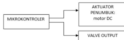
Gambar 2. Blok diagram alat pengestrak kunyit otomatis
