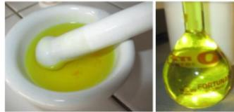
Gambar 8. Hasil pengekstrakan secara manual
