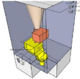
Gambar 4. Desain alat pengeskrak kunyit bagian dalam
