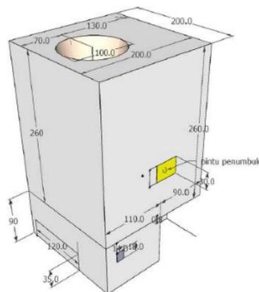
Gambar 3. Desain alat pengestrak kunyit bagian luar
