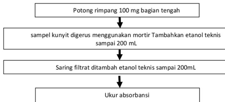
Gambar 1. Metode pengestrakan kunyit secara manual [3]
