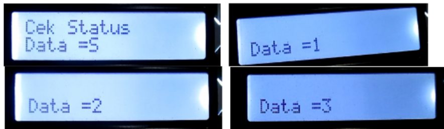
Gambar 11. Tampilan LCD master saat menampilkan status pintu air.
