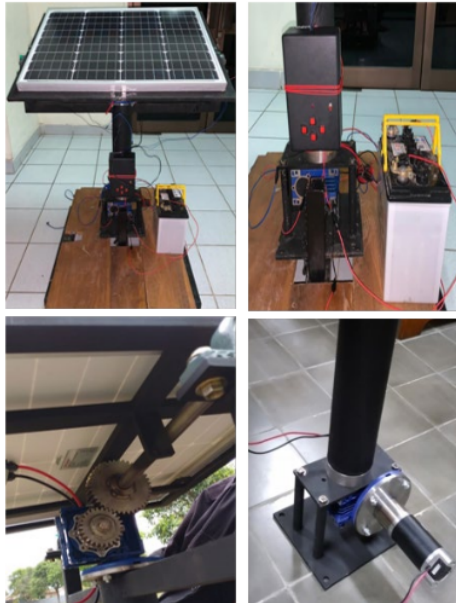
Gambar 7. Sistem mekanik pelacak cahaya
