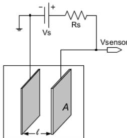
Gambar 2. Rangkaian sensor konduktivitas.
