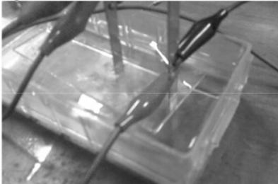
Gambar 4. Dua elektroda sebagai sensor konduktivitas air..
