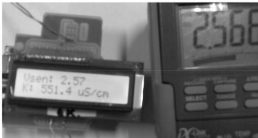
Gambar 5. Alat ukur konduktivitas (kiri) dan multimeter (kanan)..
