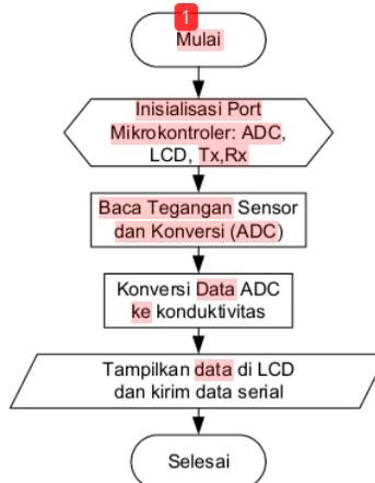
Gambar 3. Diagram alir pengukuran konduktivitas air.
