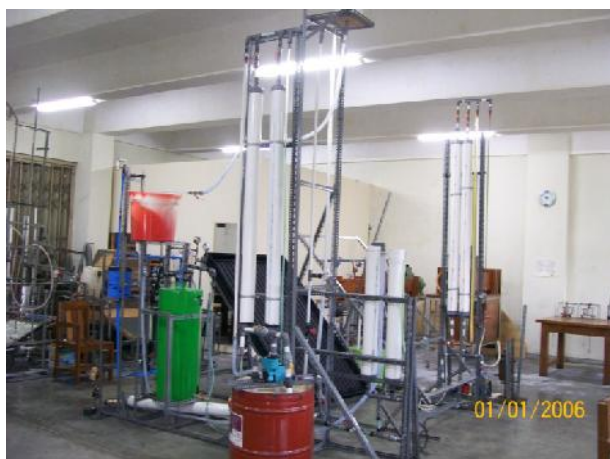
Gambar 2. Pompa termal dengan fluida petroleum ether. Head pemompaan adalah 3 m.
