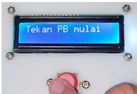
Gambar 20. Tampilan LCD sebelum push button ditekan
