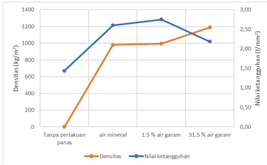
Gambar 93. Hubungan densitas fluida dan nilai ketangguhan Baja AISI 1045
